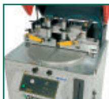
Sistema automático de rotación de los prensos horizontales al desbloqueo para facilitar las operaciones de carga y descarga del perfil a trabajar
