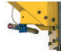
Un apuntador laser permite la regulación en altura de la mordaza neumática independientemente del conocimiento de las dimensiones de la carpintería a embalar
