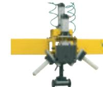
La mordaza neumática está dotada de un dispositivo que previene el vuelco accidental de las puertas y ventanas durante el desplazamiento; este dispositivo se excluye automáticamente una vez efectuado el bloqueo, permitiendo un envolvimiento completo del producto
