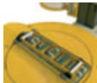
La mesa de rodillos de carga y descarga desciende automáticamente durante el embalaje, poniendo las puertas y ventanas en contacto con una superficie de caucho que evita su desplazamiento lateral
