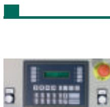
PLC para inserción de listas de trabajo, temperatura, y tiempo de soldadura en función de la sección de la junta
