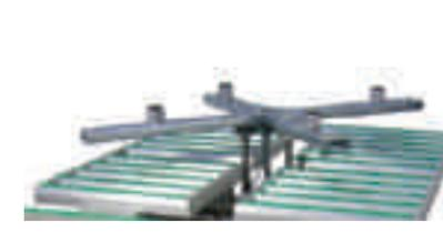
El sistema de levatamiento pivotante está provisto de soportes telescópicos revestidos con goma para el apoyo del cristal
